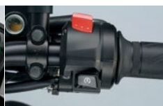
Suzukijev „Easy Start“ sistem
