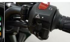
Suzukijev „Easy Start“ sistem
